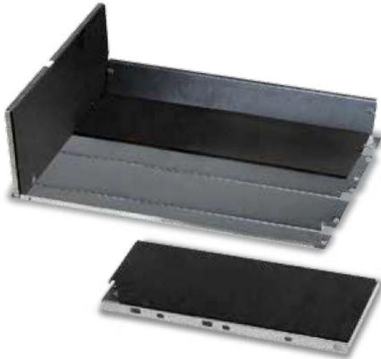
بدنه کلیه فن کویل های شرکت تهویه از مرغوب ترین ورق گالوانیزه ساخته شده است که با دقت و حساسیت بالا از سوی واحد کنترل کیفی، بازرسی و کنترل می شوند. به تناسب نوع و مدل فن کویل از ضخامت های مختلف در ساخت بدنه از این ورق ها استفاده می شود. جهت جلوگیری از هدر رفتن حرارت، برودت و همچنین کاهش سطح صدای دستگاه، جداره داخلی با استفاده از عایق های پشت چسب دار الاستومری پوشش داده می شود.
